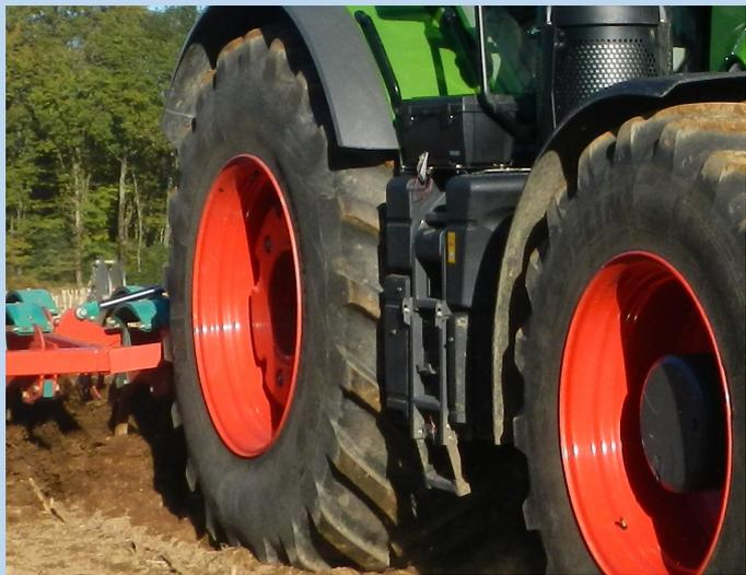
**Critère visuel:** 3 crampons au minimum sur sol ressuyé, pour augmenter la surface de contact au sol et limiter la pression au cm<sup>2</sup> (attention à adapter la pression des pneus (de 0.8 à 1.5 bars)
