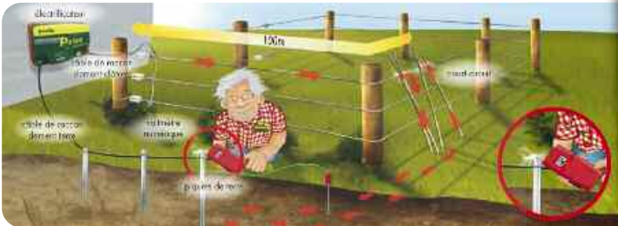
Un contrôle régulier de la prise de terre, surtout si le sol est très sec, garantit une plus grande fiabilité de la clôture.
